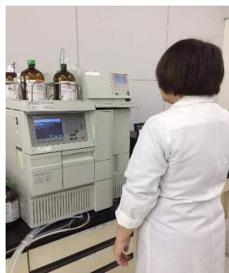
保存料検査：HPLCによる測定
