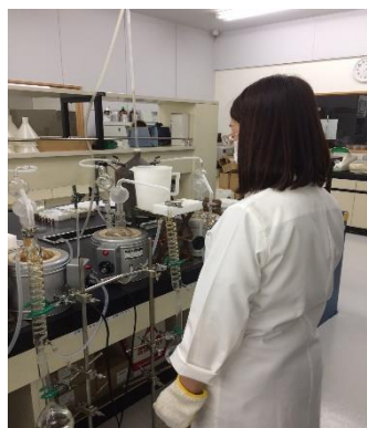
保存料検査：水蒸気蒸留による抽出
