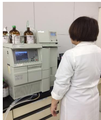
保存料検査：HPLCによる測定
