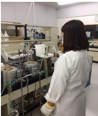
保存料検査：水蒸気蒸留による抽出
