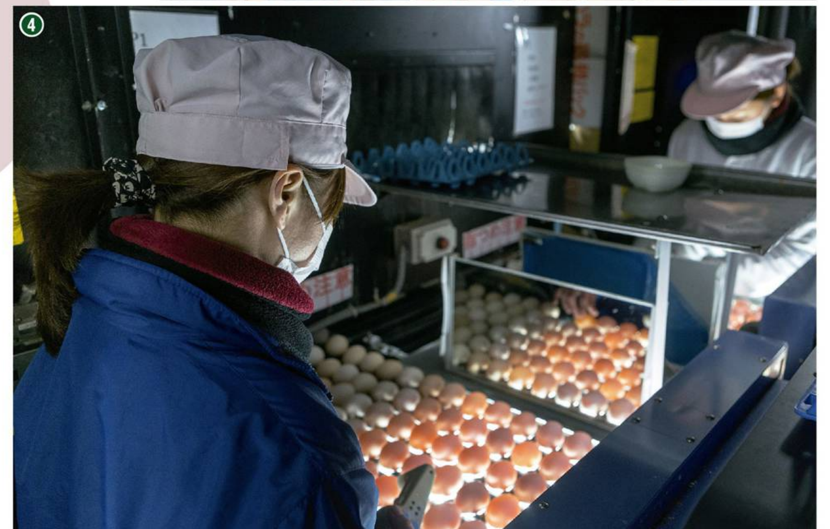
④ 透過させて / 洗卵・乾燥を終えた卵は透過光でもチェック。血卵やヒビ割れの除去に努める。
