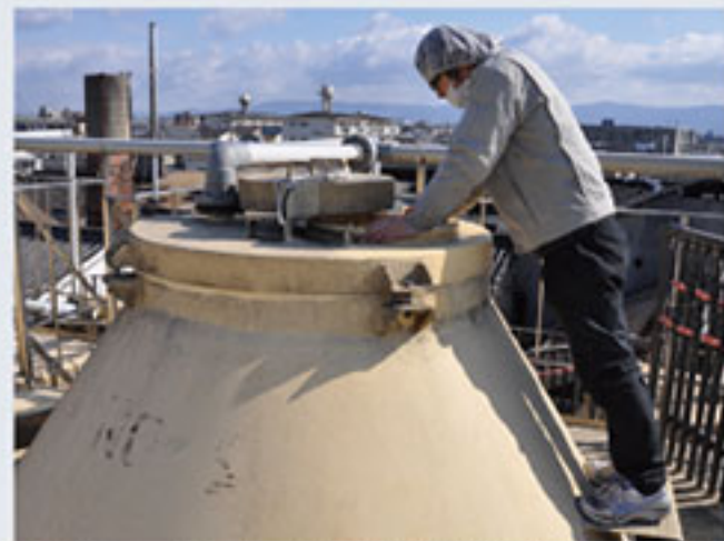
②製麹 大豆と小麦、麹菌を混ぜて、麹を作る工程です。
