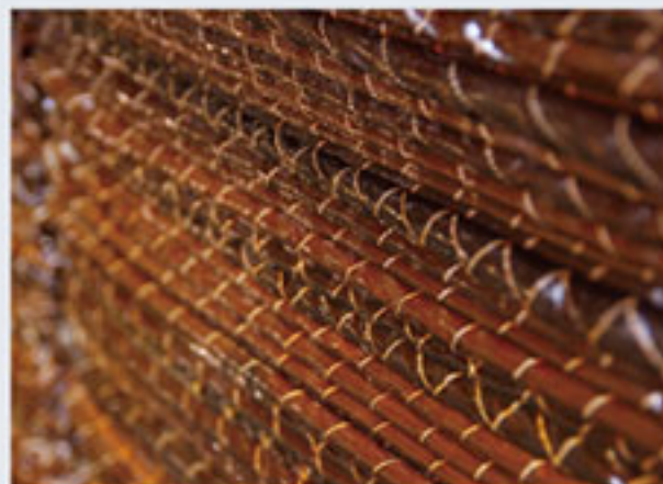
④圧搾 熟成した諸味を自重で搾ります。自重で搾りきった後は、油圧で押しつけて水分が無くなるまで搾ります。
