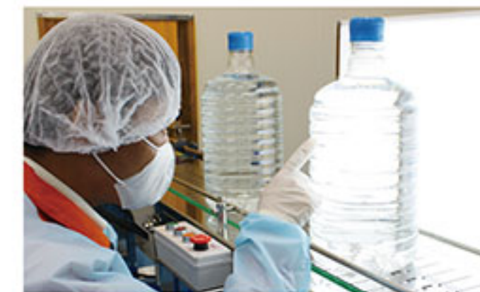
③異物混入・水量の確認を行います。
