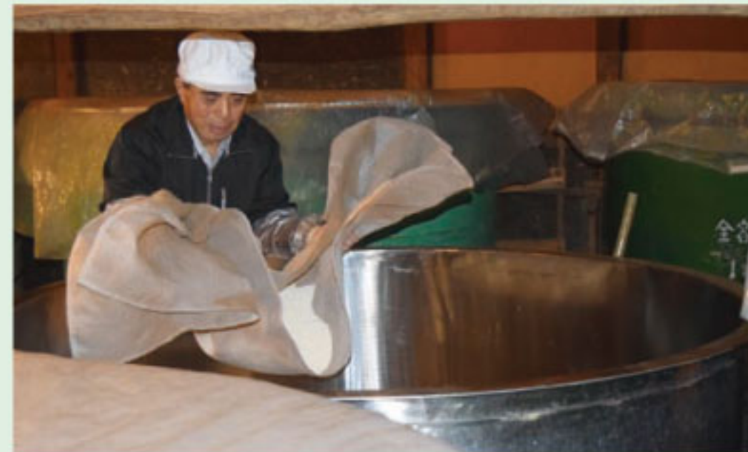
④仕込みタンクに蒸し米を入れる
