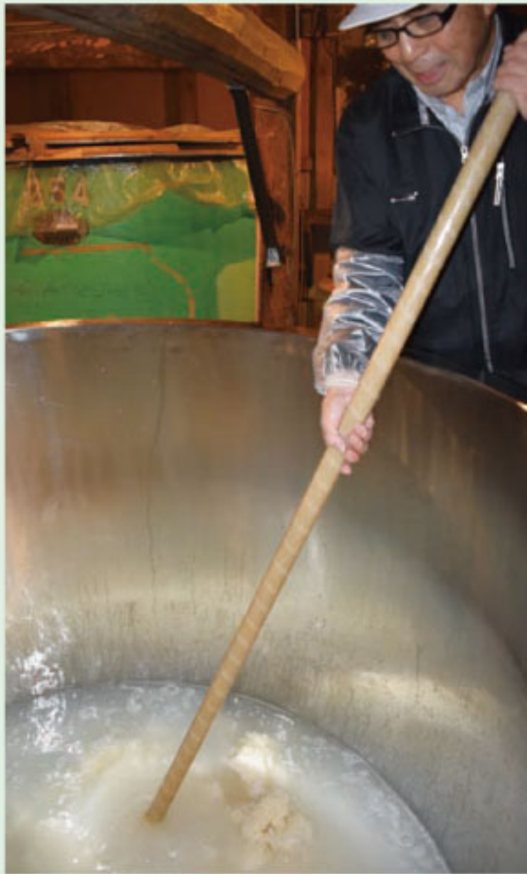
①糠(かい)入れをして酒母、蒸し米、麴を混ぜる
