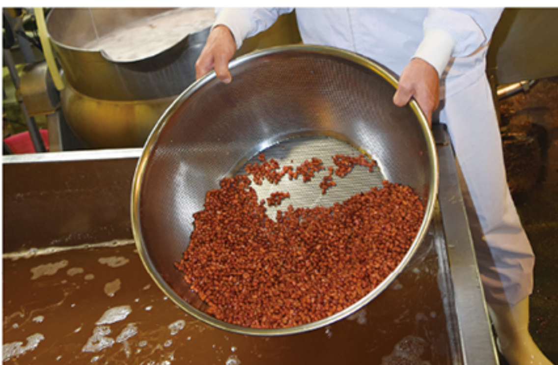
④約20時間水に浸す。浸した(浸漬液)は後で使用
