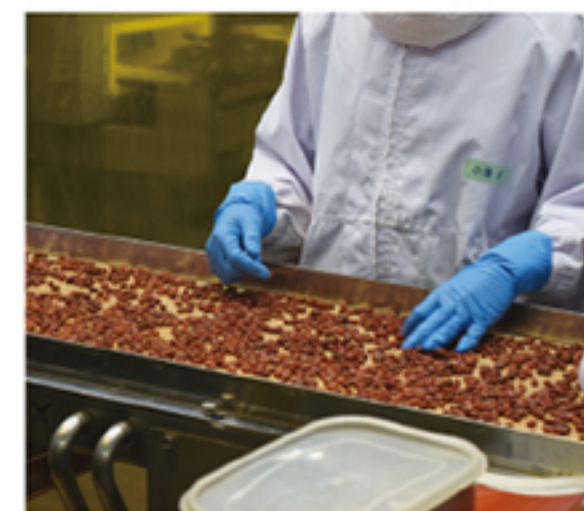
⑨3〜4人で皮裂け、割れ、小粒他不良品を徹底目視選別
