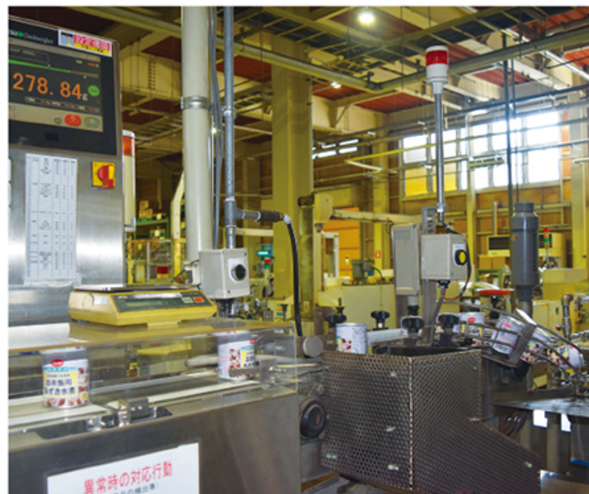
⑮缶状態での最後のウエイトチェックからローラー式に缶の汚れを確認
