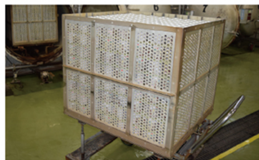
⑫バスケットクーラーに缶を整然と詰めた後、118℃のレトルト釜で加熱殺菌処理
