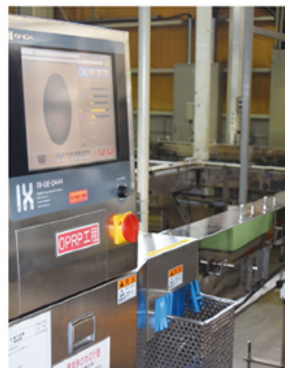
⑭X線検査で最後の金属等異物チェック
