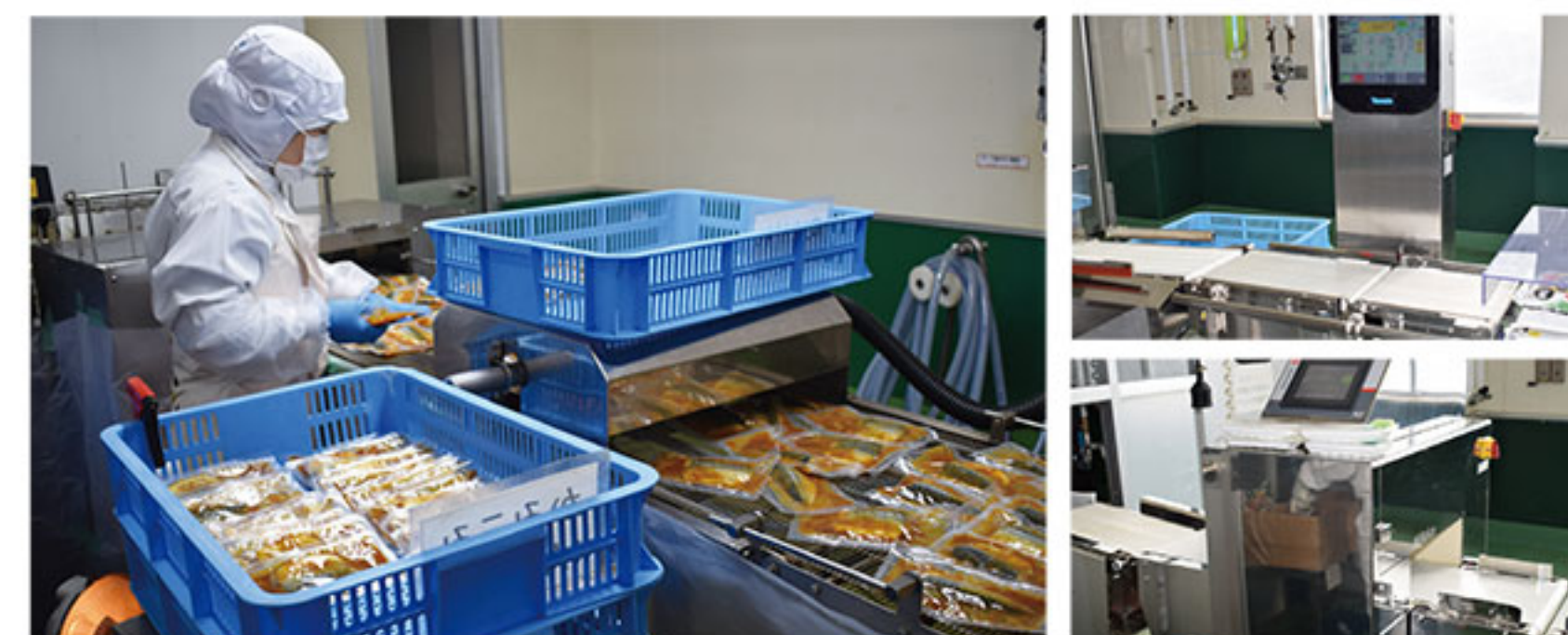
ウエイトチェッカーと金属探知機、人による目視で商品に異常がないか確認している
