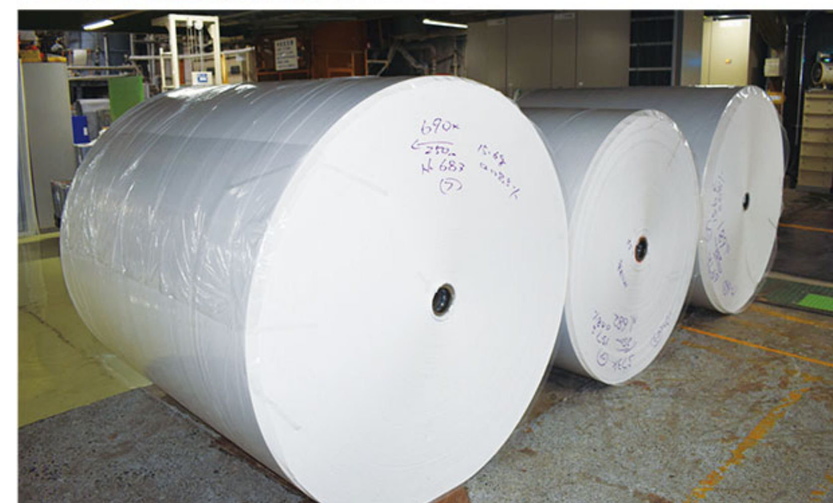
抄紙機でトイレットペーパーの原紙であるジャンボロールが作られる
