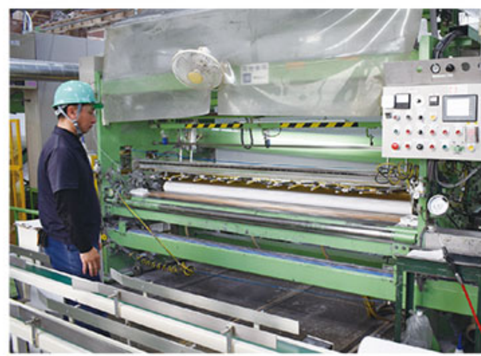
ジャンボロールはトイレットペーパーの長さに巻き戻される
