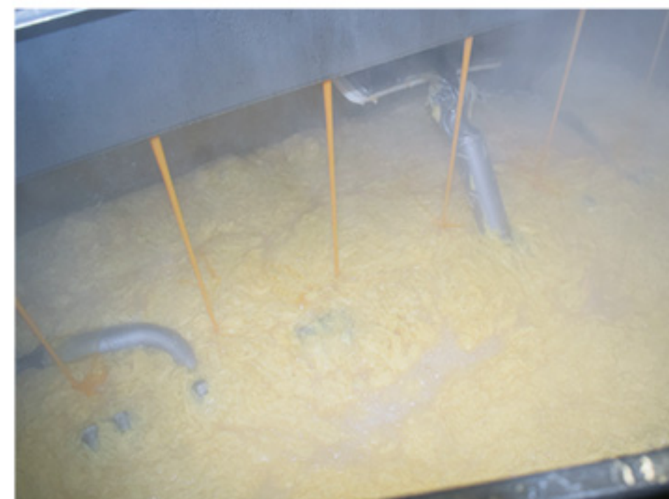
ニーダーに投入された液卵と調味料を加熱、攪拌
