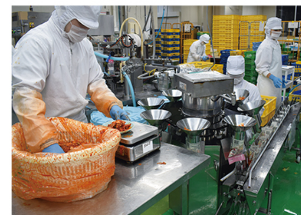
手作業で計量して機械でパックに詰める
