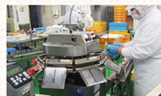
⑦袋詰め後、圧着シールを点検して金属探知機(手前)へ。
