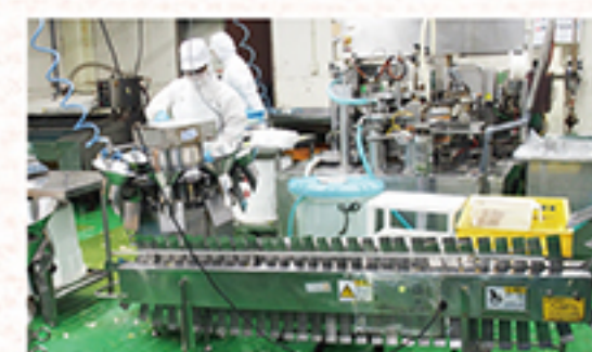
⑥計量・袋詰め工程。商品が変わるたびにラインを洗浄。
