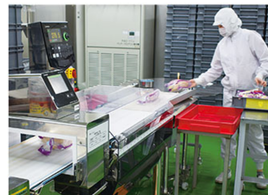
⑥異物混入の対策として金属探知機、ウエイトチェッカーで確認
