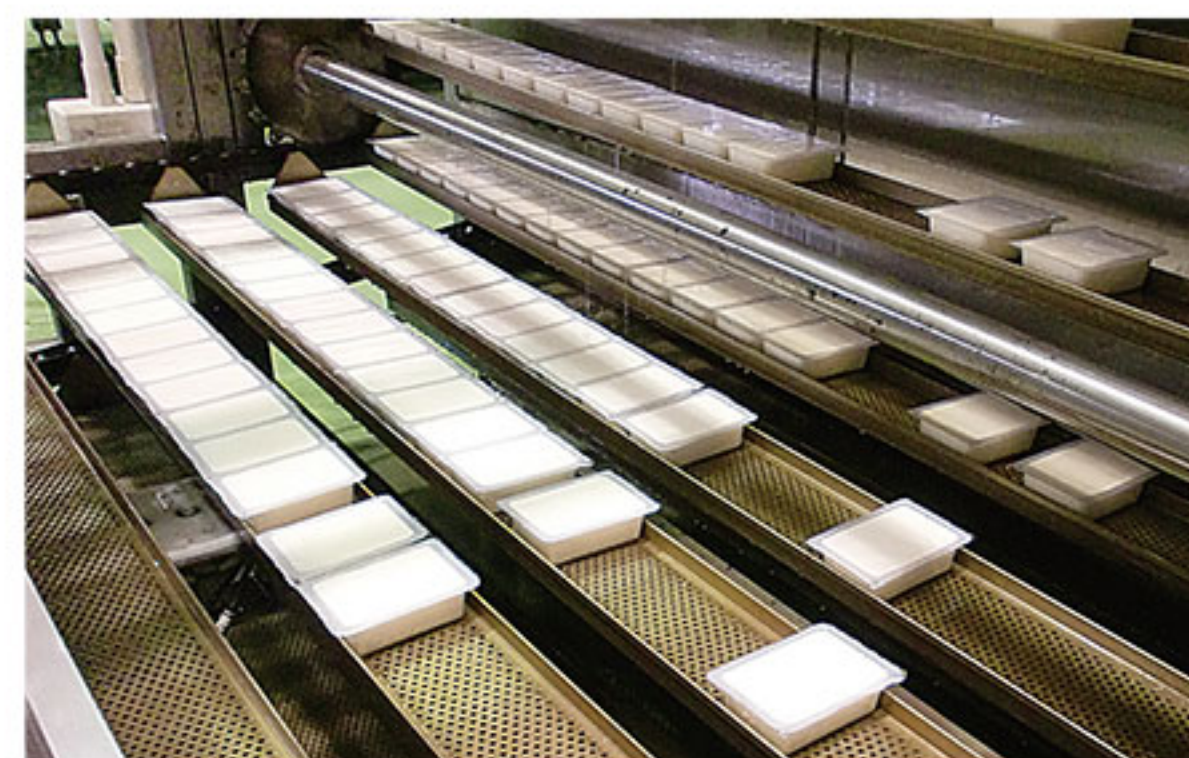
充填豆腐の工法は水にさらすことなく凝固させることができる
