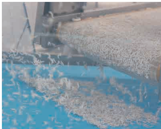
乾燥機の中で煮あがったしらすの水分をとばします
