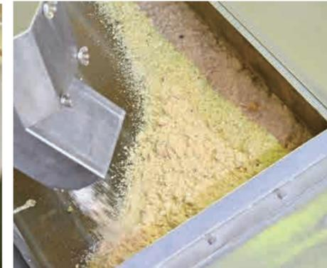
混ぜ合わせた原料が乾燥機の中を通過して粉末に変身します
