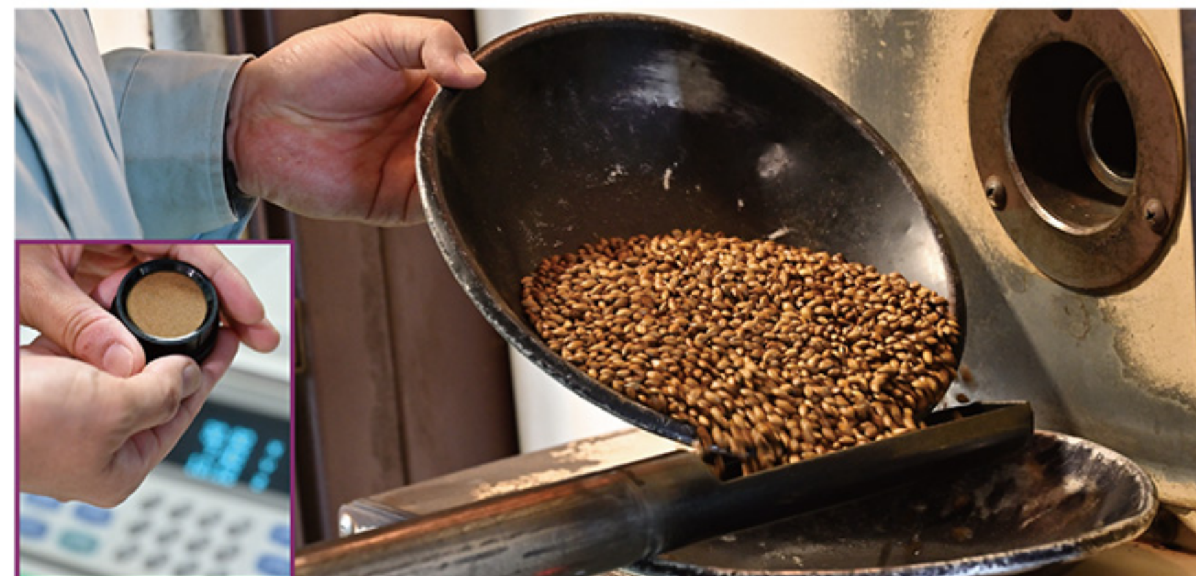
焙煎具合を確認するため、製品の色を測定
