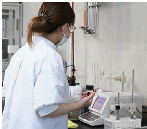
製品のpH（水素イオン濃度）検査（品質検査室）
