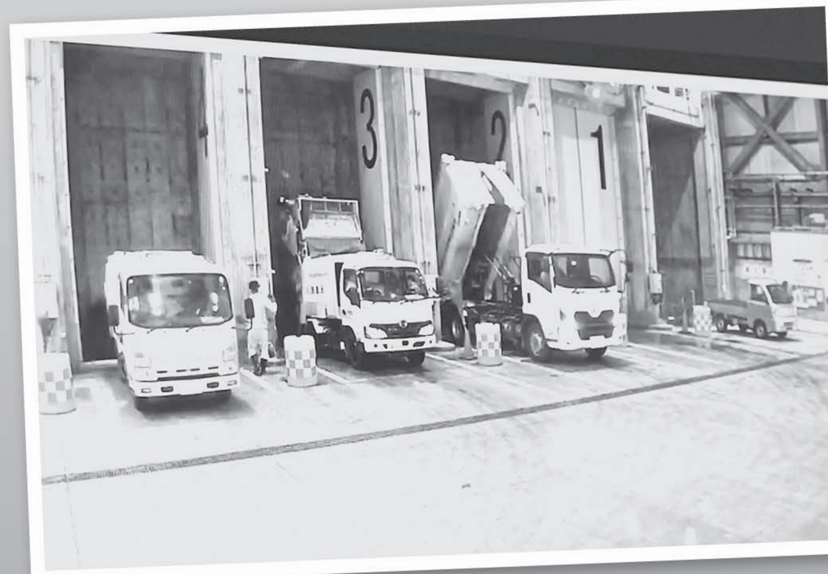
プラットフォームからごみピットに投入するごみ収集車
