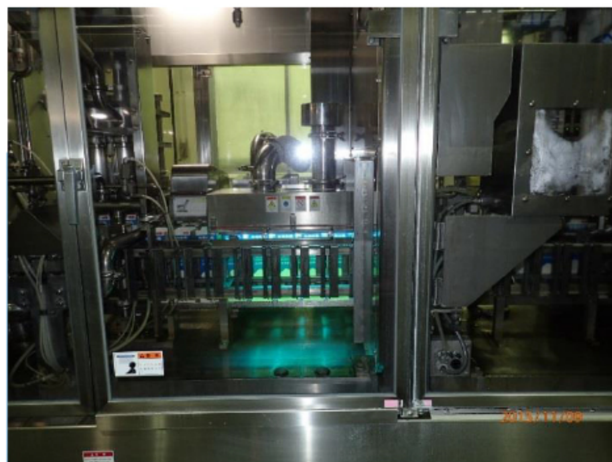
UPN-65型充填機でのUV殺菌工程。 ここでカートンを殺菌します。
