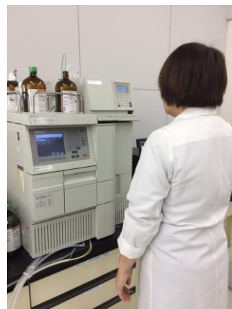
保存料検査：HPLCによる測定
