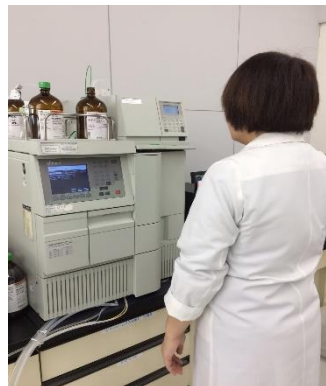
保存料検査：HPLCによる測定
