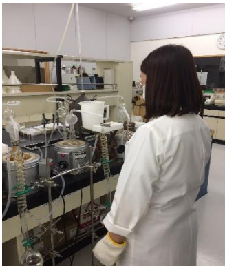
保存料検査：水蒸気蒸留による抽出
